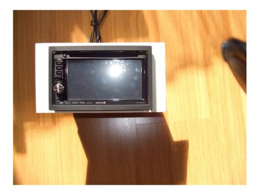
Den Sperrholzrahmen bringt man in der Öffnung des Radioschachtes an. Am besten vorher aber noch (falls vorhanden) dieses Plastikteil abschrauben dann hat man mehr Platz hinten. Ist wohl ursprünglich als Auflage für ein einfach DIN Radio gedacht – kann bedenkenlos entfernt werden. Die Schrauben unten dienen zur Befestigung.
