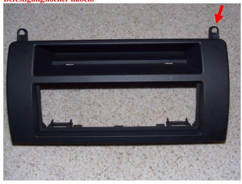
In diesen Rahmen anhand der Maße des Metallkäfigs, der beim Radio dabei ist, eine Öffnung aussägen. Damit der Rahmen nicht nach hinten rutscht habe ich als Abstandhalter, auf Höhe der alten Befestigungslöcher, oben zwei Dübel eingesetzt die
