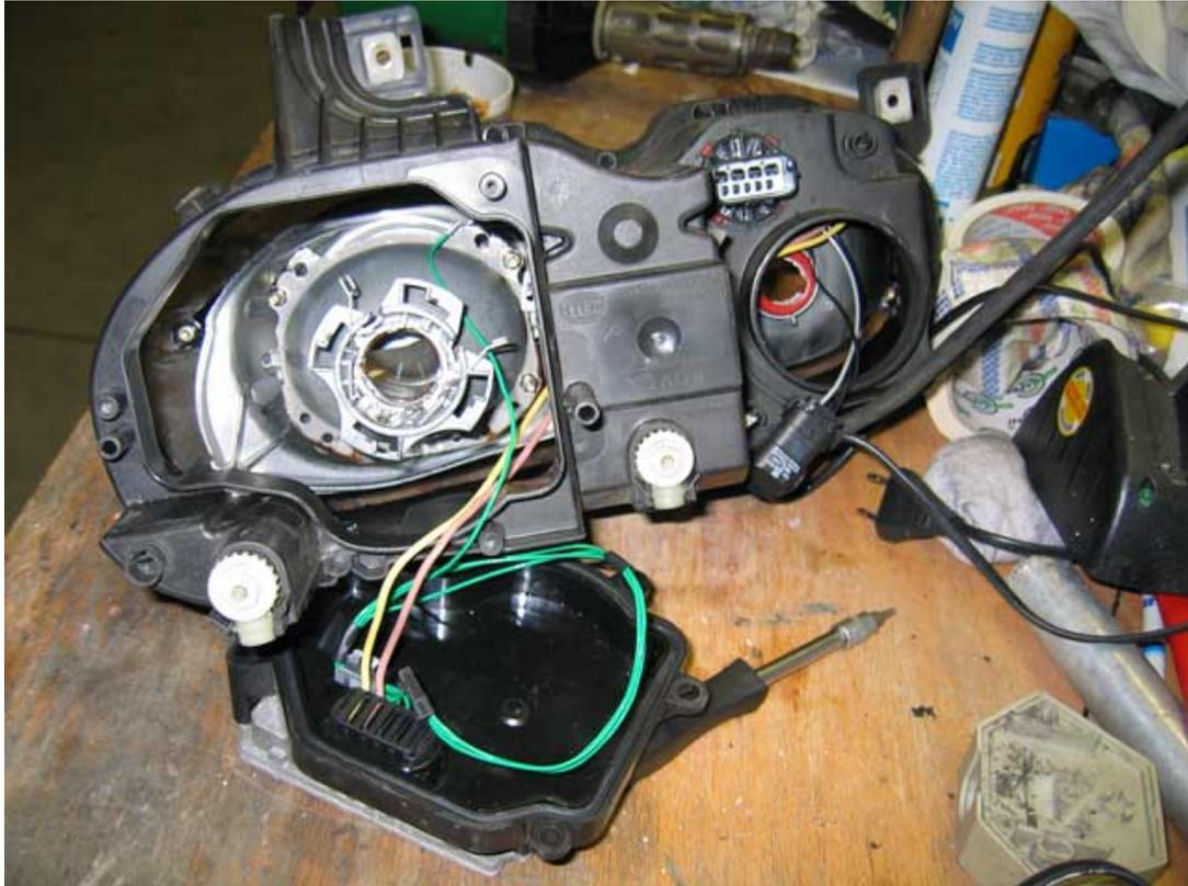
Nice to know: auf dem Bild sieht eines meiner Lieblingsspielzeuge...der berühmte "Leister" von Bosch. Ein Heißluftgerät von 0 bis 400 °C stufenlos einstellbar. Hier fahre ich ca. 50 bis 60°C.
