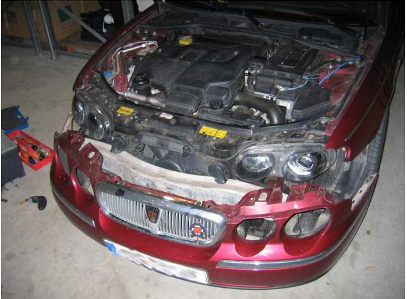
Der Schweinwerfer selbst ist mit 4 Schrauben befestigt. Nachdem dem Lösen zieht man den Scheinwerfer etwas raus und trennt dann hinten erstmal das Kabel. Man muss mittig auf den Stecker drücken, damit man ihn abbekommt.
