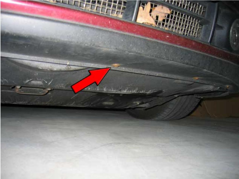
Ist das geschafft, geht man an die Seite zu den Radkästen. Dort sitzt eine Schraube, die man mit einer 10er Nuss lösen muss. Am besten man solch ein flexibles Drehstück, wie auf dem Bild zu sehen ist.
