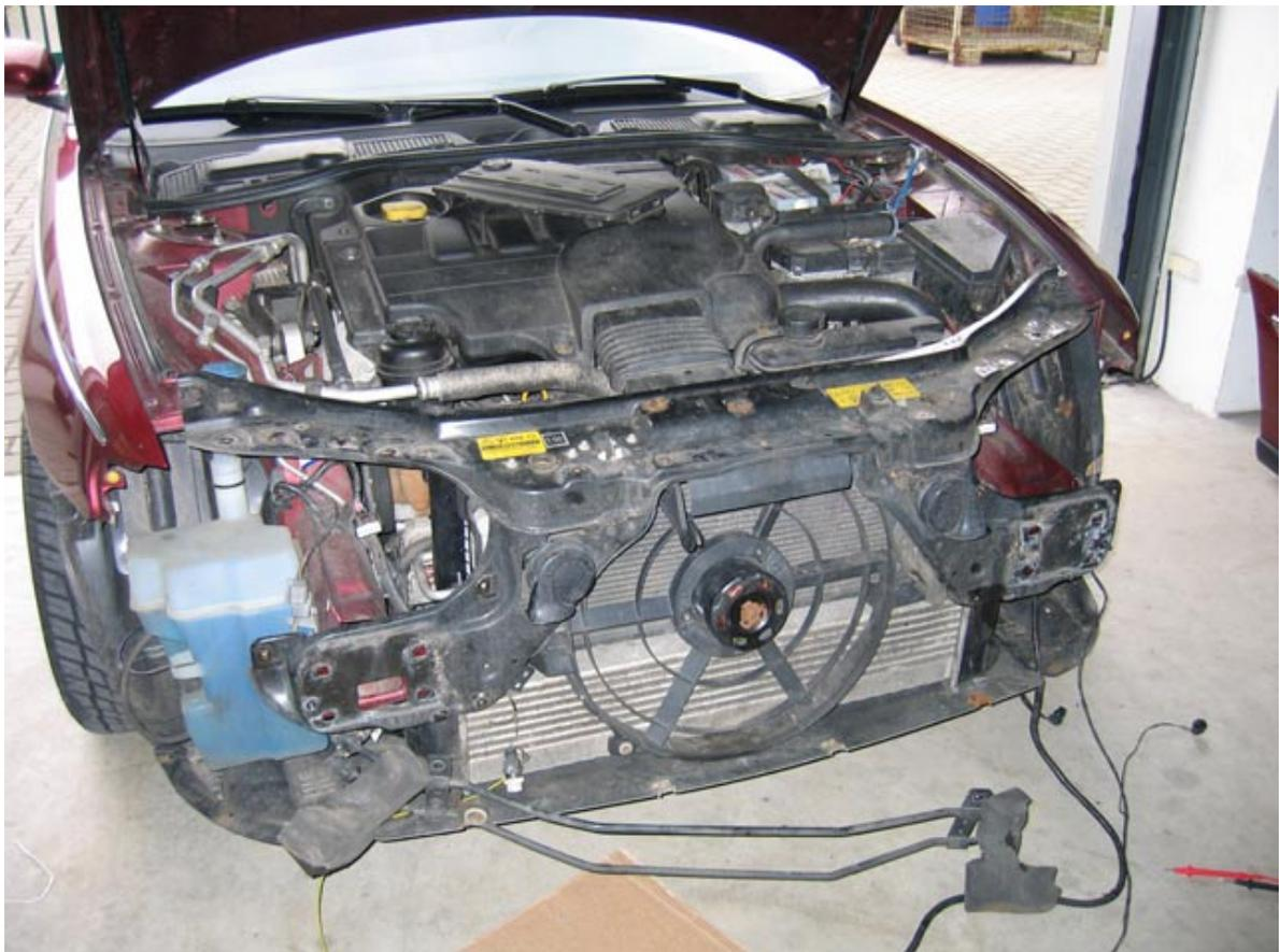
Hier angekommen, kann man diesen ganzen Lüfteraufbau an der rechten Seite aushängen. Auf der anderen Seite gehen durch die Konstruktion noch Leitungen durch und die sollte man besser nicht lösen, weil sonst Flüssigkeit austritt. Jetzt kommt man aber endlich an die Schrauben ran, die schlauerweise nur von hinten zugänglich sind und nicht von vorne. Dann hätte man sich das alles hier sparen können.
