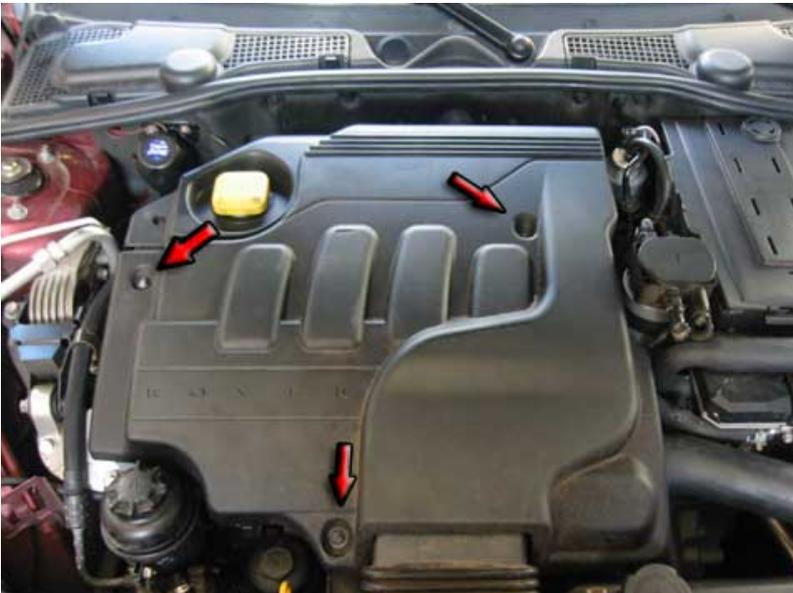
Den Motorraum öffnen und die 3 mit Pfeilen gekennzeichneten Schrauben mit einem 10er Steckschlüssel bzw. Knarre und 10er Nuss lösen. Danach den Deckel entfernen.
