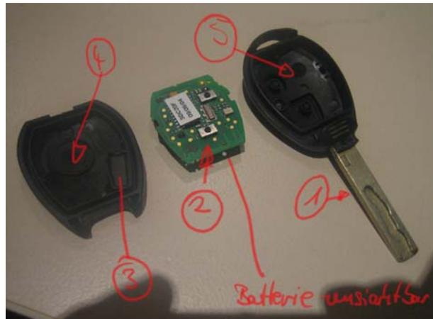
Um an die Platine z.B. für den Batteriewechsel zu kommen hebt man den Schlüssel mit einem flachen Schraubendreher auf, vorsichtig aber mit Nachdruck.
